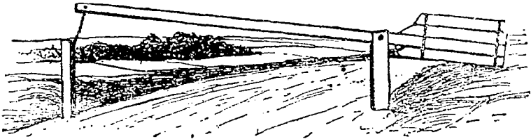
Рис. 114. Шлагбаум — рычаг первого рода.
