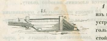
1 творило для приготовленія раствора изъ извести, песка и воды. Этотъ ящикъ устроивается въ выкопанной четыреугольной ямъ. По угламъ ея вколачиваются стоймя четыре доски а; бока и полъ забираются досками. Вода, или наливается, или проводится жолобомъ в.
