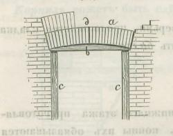
82. ныхъ, такъ и оконныхъ, выводятся перемычки изъ кирпича. Прямыя перемычки а кладутся по примкнутымъ къ верхней перекладинъ рамы доскамъ в, снизу подпертымъ досками или брусками с. Способъ кладки перемычекъ изображенъ на фигуръ, равно и направленіе, которое должны имъть кирпичи. Средній кирпичь в отесывается клиномъ и вставляется, когда перемычка съ объихъ сторонъ уже сведена.
