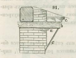
91. Первые ряды илитянаго корниза выкладываются изъ притесаннаго по шаблону \*) кириича а; они покрываются корнизною плитою в, положенною такъ, чтобы перевъсъ ея быль на стънъ, для чего плита и выпускается въ наружу не болье какъ на 1/3 своей длины. Направление ея опредъляется
