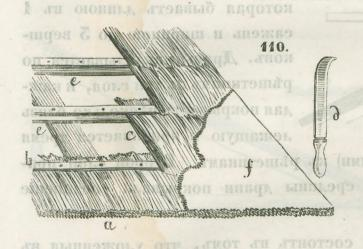
Крыши, извъстныя подъ названіемъ дорновыхъ, (по имени изобрътателя), дълаются изъ пучковъ соломы, предварительно омоченныхъ въ растворъ жидкой глины. Эти сырые пучки сначала укладываются по нижнему краю крыши а придерживаются поперечнымъ брускомъ b, прибитымъ деревянными или желъзными гвоздями къ ръще-
