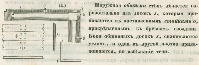
Наружная общивка стънъ дълается горизонтально изъ досокъ з, которыя прибиваются къ поставленнымъ стойкамъ о, прикрѣпленнымъ къ бревнамъ гвоздями. Бока общивныхъ досокъ з, скашиваются угломъ, и одна къ другой плотно прилаживаются, во избъжание течи.
