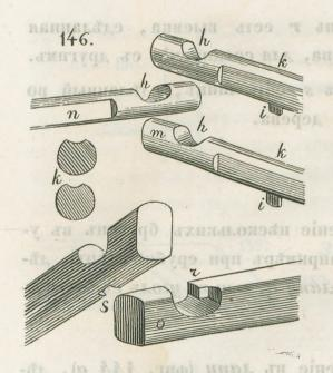
Соединение въ уголъ съ остаткомъ (наиболъе употребительное по прочности и легкости въ работъ), дълается посредствомъ полукруглаго выруба h, въ который ложится следующее бревно; сверхъ того, какъ и во всёхъ способахъ рубки стёнъ, бревна насаживаются на шипы і, и у каждаго вынимается продольный жолобъ к. При этомъ способъ, часть бревна т оставляется круглою, остальная же п отесывается снутри.
