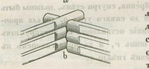
Соединение въ лапу (фиг. 144 а), дълаеть уголь строенія чистымь и удобнымь для гладкой обшивки стънъ досками, какъ снаружи такъ и снутри, а также и для оштукатуриванія. Бревна, обыкновенной толстоты, отесываются съ концовъ с съ двухъ сторонъ; толстыя же d, можно отесывать съ четырехъ сторонъ. Если же бревна оставляются круглыми, то вдоль ихъ вынимается жолобъ е, прокладываемый, во время рубки стынь, мхомь; оть чего бревна будуть плотно лежать одно на другомъ.
