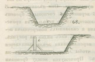
На песчаномъ грунть, по сдъланіи разбивки строенія, т. е. обозначеніи его плана вбитыми кольями и натянутыми шнурами (см. стр. 10) выкапывается для фундамента ровъ до материка, или до той глубины, на которой песокъ лежитъ твердо, не подается отъ удара ломомъ, и издаеть ясный звукъ.
