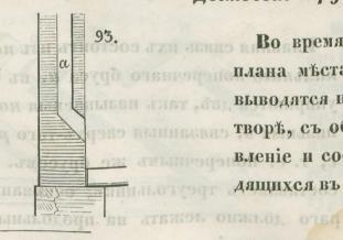
93. Во время кладки стѣнъ обозначають съ плана мъста для дымовыхъ трубъ а, и онъ начен альт до выводятся изъ кирпича на известковомъ растворъ, съ обмазкою внутри глиною. Направленіе и соединеніе дымовыхъ трубъ, находящихся въ стънахъ, опредъляется по плану.
