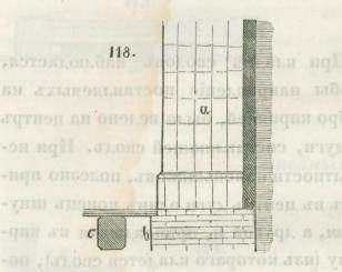
Подъ печи а нижняго этажа выводится фундаменть b, котораго верхняя поверхность должна быть на-ровнѣ съ балками с. Для печей же верхняго этажа, закладываются въ стѣны такъ называемые кронштейны f (фиг. 119), сдѣланные изъ полоснаго желѣза на ребро, поддерживающіе всю тяжесть печи.
