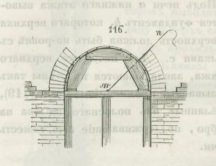
При кладкъ сводовъ наблюдается, чтобы направленіе поставляемыхъ на ребро кирпичей, было ведено на центръ т дуги, составляющей сводъ. При неопытности каменьщиковъ, полезно прибить въ центръ дуги одинъ конецъ шнура т, а другой п, прикладывая къ кирпичу (изъ котораго кладется сводъ), повърять его направленіе.
