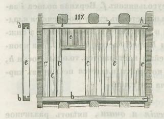
Для сдъланія деревянныхъ переборокъ или перегородокъ кладется на балки брусъ b, въ него вставляются вертикальныя стойки c, на которыя насаживается верхній брусъ d. Въ обоихъ предварительно вынимають пазы и вставляются доски или тесаныя бревна e, имъющія на концахъ шипы. Стойки укръпляются къ стънамъ или балкамъ, жельзными ершами h.
