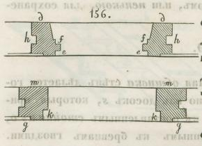
энадхоз вы отоманая или жиох Косяки оконные состоять изъ рамы d, одинаковой толщины съ бревнами. Въ нихъ дълается одинъ уступъ для лътняго переплета въ наружу е, а другой f во внутръ, для зимняго, и сверхъ того, вынимается четверть д, для досокъ наружной общивки.
