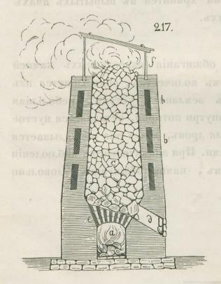
Внизу ен находится горнило (а) для дровъ, покрытое дырчатымъ сводомъ (е) для прохода огня. Стъны печи имъютъ 1 арш.: толщиныи внутри ихъ оставляютъ пустоты (b), наполняемыя пескомъ, для лучшаго удержанія тепла. Съ одной стороны дълается косое отверстіе (выгребъ d), для выгребанія обозженнаго камня. Для защиты печи отъ дождя, устроиваютъ на верху ея, легкій деревянный навъсъ f.
