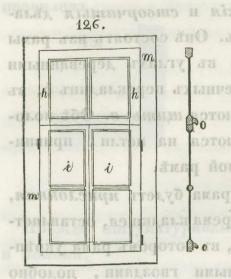
126. Оконные переплеты лётніе и зимніе дёлаются изъ дерева и состоять изъ обвязки h, прибиваемой къ закладной рамъ m и двухъ половинокъ i, привъшенныхъ къ ней же на петляхъ k.
