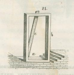
Въ промежуткахъ, назначенныхъ для дверей а, становятся закладныя рамы в, предварительно приготовленныя. Положеніе ихъ повъряется отвысом и саженью, и онъ подпираются сзади деревянными подпорками с.
