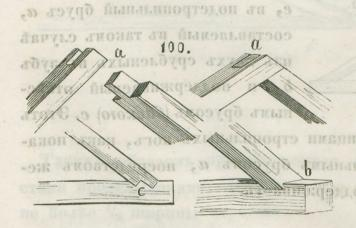
Верхніе углы стропильныхъ ногъ срубаются възамокъ а; нижніе ихъ концы врубаются въ подстропильный брусъ, посредствомъ одного в, или нъсколькихъ зубъевъ с. Врубка регеля въ стропила показана на фигуръ 101, f.
