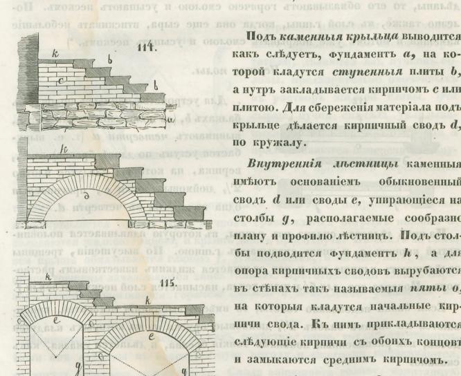
Подъ каменныя крыльца выводится какъ слъдуетъ, фундаментъ а, на которой кладутся ступенныя плиты в, а нутръ закладывается кирпичомъ с или плитою. Для сбереженія матеріала подъ крыльце дълается кирпичный сводь d, по кружалу.
