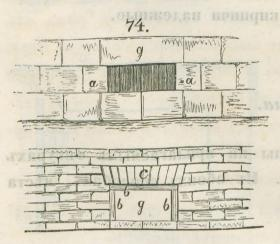
При кладкъ того ряда цокольныхъ плить, на которомъ приходятся продушины у, обозначаются, по размъру, мъста ихъ наложеніемъ угловыхъ камней а, между которыми дълается подстилка изъ досокъ в. Эта подстилка должна имъть форму продушины; она обкладывается плотно снаружи плитами, а снутри дълается перемычка с. Въ послъдствіи, эта подстилка вынимается.
