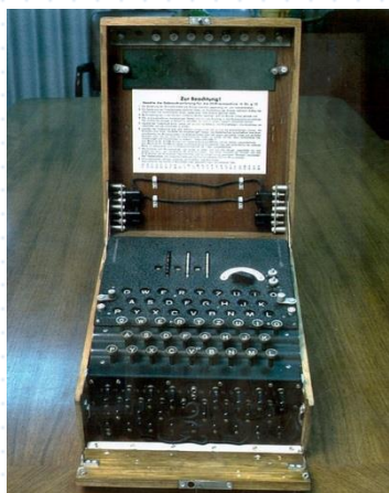
Трёхроторная военная немецкая шифровальная машина «Энигма» (версия с метками)
