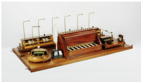
Электромагнитный телеграфный аппарат Павла Шиллинга, 1832г.
